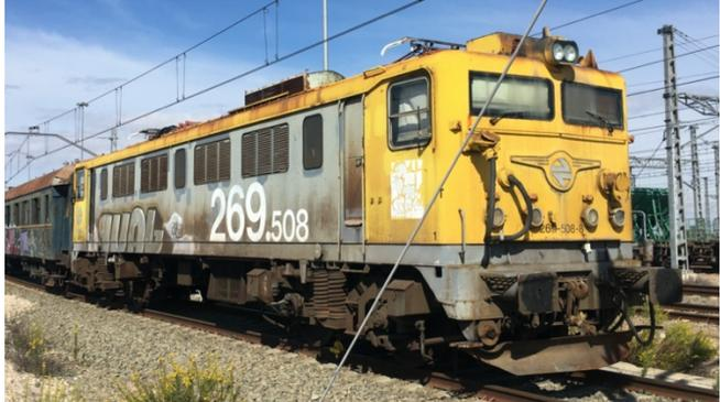
A yellow and grey electric locomotive, viewed from the front, on a track.                                       | <p><b><u>Matrícula: 269-508</u></b></p> <p>Tipo: locomotora eléctrica<br/>Año: 1977<br/>Constructor: Cenemesa (España)<br/>Estado: pendiente de restauración<br/>Propietario: RENFE-FFE</p>              |
